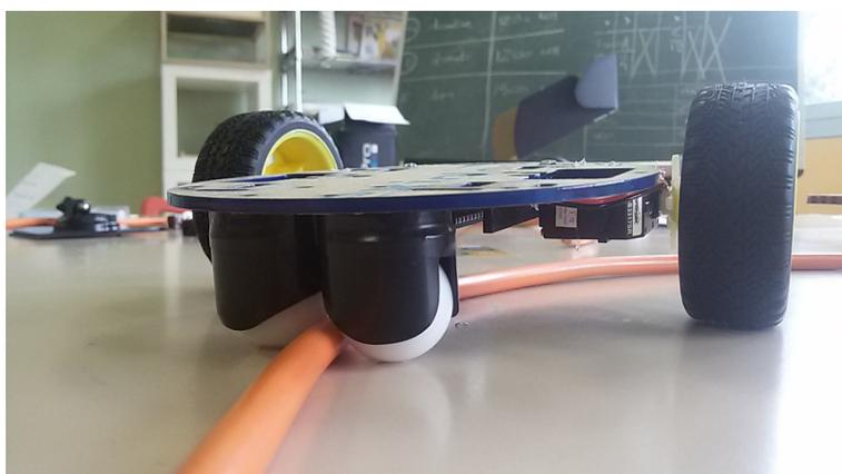
Qui sopra un dettaglio del carrello. Le due ruote spingono la struttura lungo il cavo. In questo modo il nostro time-lapse avrà un maggiore effetto scenografico grazie al percorso che decidiamo di fargli fare.
