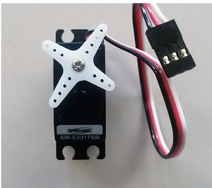
Inseriamo un modulo a X sopra il motorino e fissiamolo con una vite (questi componenti sono presenti in ogni motorino)
