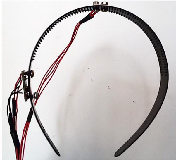
In alto il magnetometro fissato nella parte alta del cerchietto (questa operazione verrà eseguita più avanti), in basso a sinistra l'accelerometro.
