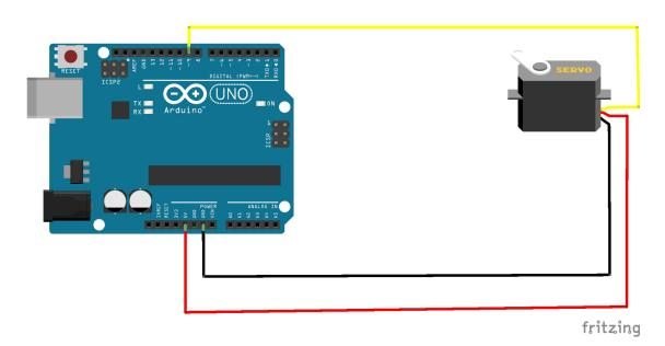
I motorini 360° si collegano esattamente come quelli bloccati a 180°. Oltre all'alimentazione Vcc (5V) e la massa (GND) colleghiamo il cavo giallo al pin 9 di Arduino (il pin9 gestirà i comandi del motorino).
