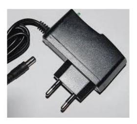
Questo tipo di alimentatori si trovano in tutti i negozi di elettronica e hanno un costo che si aggira intorno ai 10 euro. La presa nera va collegata nell'alimentazione di Arduino (vicino al connettore che utilizziamo per uplodare il codice).
