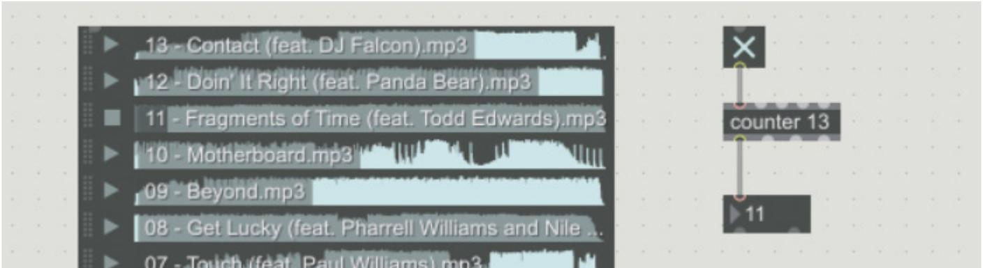
Scriviamo "**counter 13**" al suo interno. Inseriamo un interruttore (Toggle) e uniamo i due blocchi. Sotto il counter inseriamo un blocco **Number** (per vedere il risultato) e colleghiamo le due uscite. Questi tre blocchi formano un contatore. Cliccando sull'interruttore il contatore incrementa un numero da 0 a 13.
