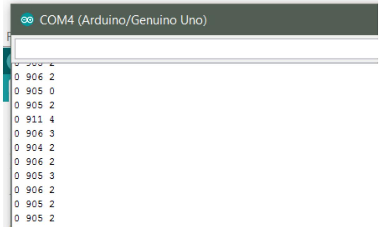
Per poter passare i dati a MaxMsp è molto importante rispettare questa forma: dato sensore (**spazio**) dato sensore 2 (**spazio**) dato sensore 3 (**spazio e a capo**). Con il comando `Serial.print(" ");` creiamo lo spazio vuoto tra i diversi dati mentre con `Serial.println(" ");` mandiamo a capo il nuovo valore. Chiudiamo Arduino e apriamo MaxMsp.
