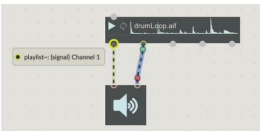
In modalità sbloccata clicchiamo sul primo pin sotto drumLoop. Trascinando il mouse si crea un cavo di collegamento che deve essere inserito nel primo pin in alto della cassa.
